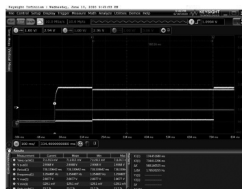
图 6 FPGA 加载配置时间长度测量结果
